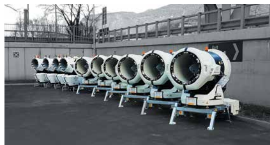
Турбины пылеподавления V22 Orca и T40
