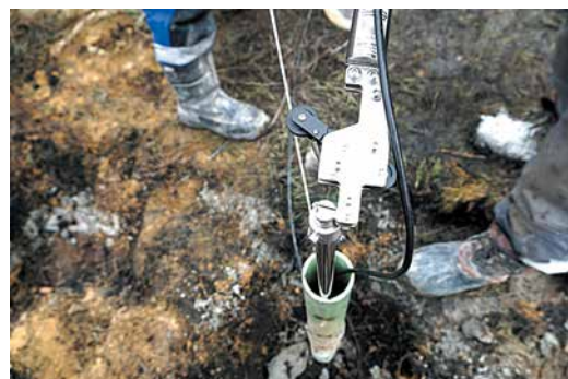
Автоматизированная система контроля выдает данные о начале глубинных смещений задолго до появления признаков деформаций на поверхности борта
