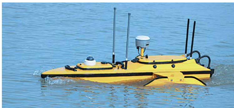
Комплекс для измерения рельефа дна позволяет обеспечить безопасность проведения маркшейдерских работ на гидротехнических сооружениях
