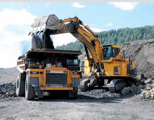
Вся карьерная техника на разрезе «Распадский» и «Коксовый» оборудована специальными датчиками. На основе показателей «умная» система-советчик выдает подсказки
